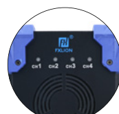
电池放电/充电工作指示灯
