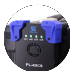
电池放电/充电工作指示灯
