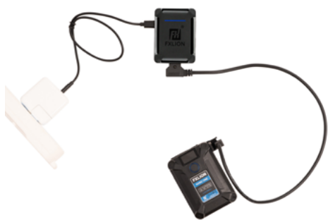
USB-C适配器输入，给电池充电
